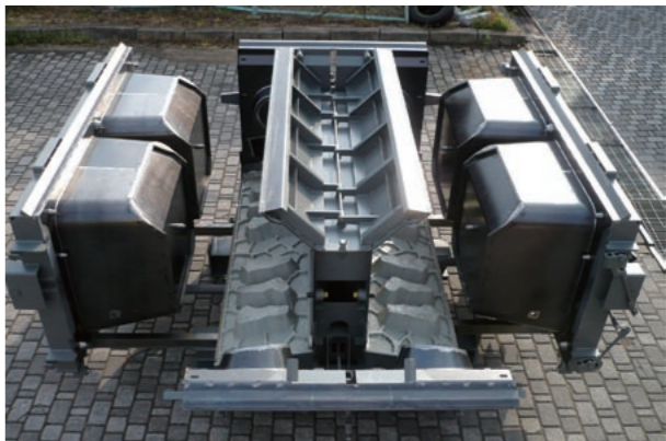
トヨタ工機が製造するPC製品の型枠。隙間に生コンクリートを注入した後、約4時間でコンクリートが硬化し、PC製品が出来上がる
