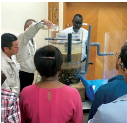
市内の中山間地域で使われている簡易ろ過装置についても説明があった。石と砂だけで作ることができ、途上国でも適用しやすいという
