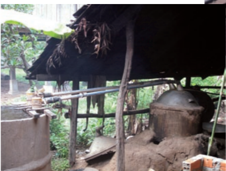
一般的な酒造農家の蒸留 装置。養豚の副業として米 蒸留酒を製造し、蒸留後の 残りかすをブタの餌にする 農家が多い。養豚の利益が 出なくなると酒造もやめてし まうことが衰退の一因だ
