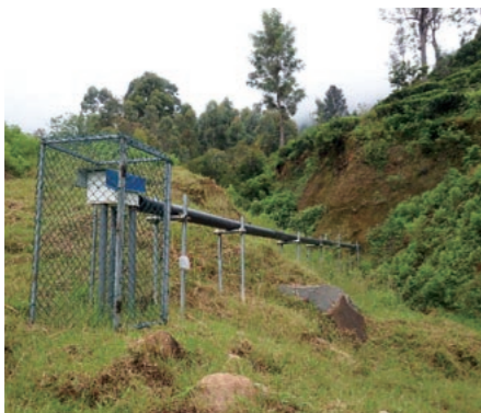
別のプロジェクトで使用されているオサシ・テクノスの地表伸縮計。地表面の変位を観測することができる
