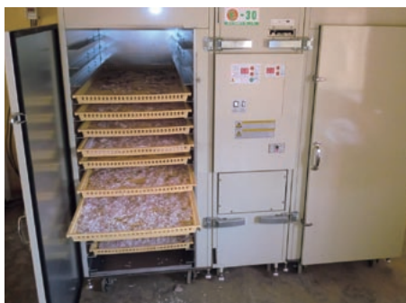
大紀産業株式会社がカッサラ州に試験導入した大型電気乾燥機
