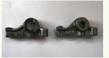
カスヤGPPオートプロダクツ社が導入した設備の一つ(上)と加工された部品(下)。部品の加工と研磨までの一連のプロセスを自動で処理することができる
