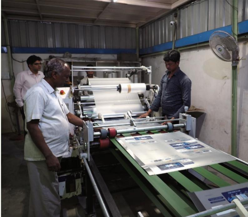
P・K・エンタープライズ社で、海外メーカーの梱包用ボックスにラミネート加工をする工員たち。同社の箱を使った商品の多くが海外に輸出される
