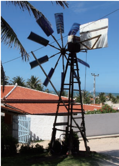
住宅地にある風車。電気のないころから、風車は水のくみ上げに使われてきた
