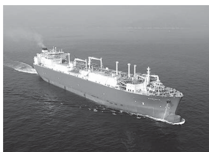
船の形を取る浮体式LNG貯蔵再ガス化設備（提供：Excelerate）
