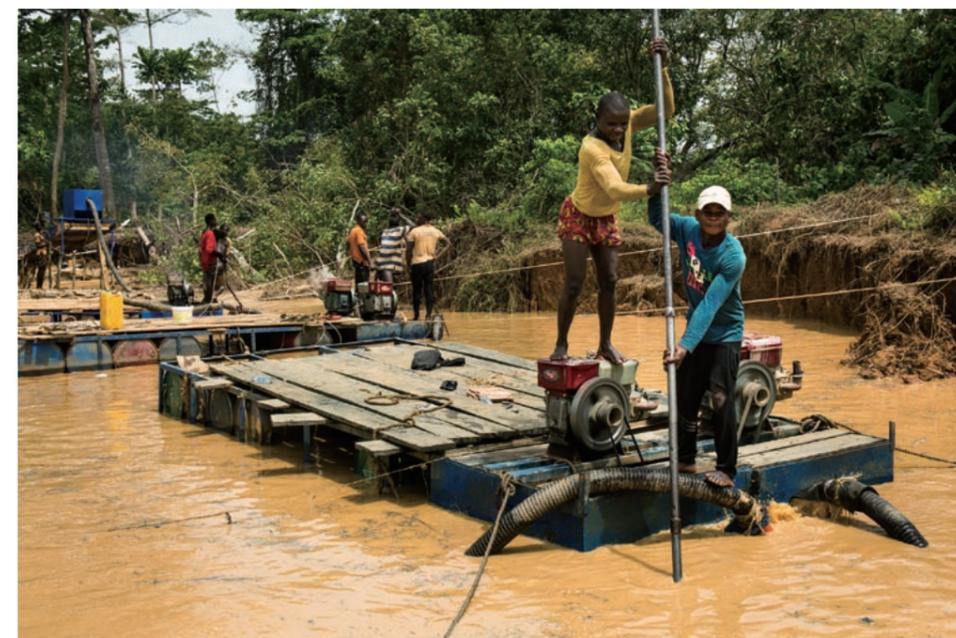
川の採掘者たち。金を含んだ泥水を吸い上げるゴムホースの位置を調整している。泥の抵抗力もあり、かなりの重労働だ
