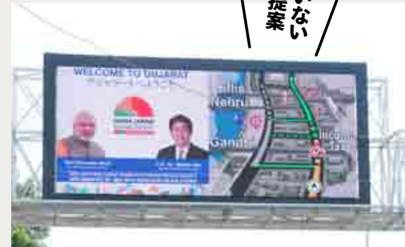
2017年9月に導入した新しい情報板。リアルタイムの渋滞情報にもとづき、ルートの誘導を行う。
