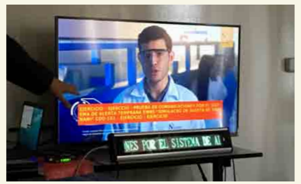
テレビと文字ディスプレイに表示されるEWBSの訓練メッセージ。
