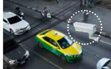
通行する車両台数を計測するカメラ。バンコク市中心部のラマ6世通り、約1キロの直線区間で信号機を系統制御するテストを行い、渋滞緩和の効果が見られた。
