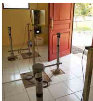
観測井戸。1か所につき深さの異なる3本の井戸を建設している。各井戸は二重構造になっており、地盤が沈下するとその分だけ内側のパイプも沈む。3本の井戸のパイプの沈み具合の差で、各地層での収縮の度合いを計測する。
