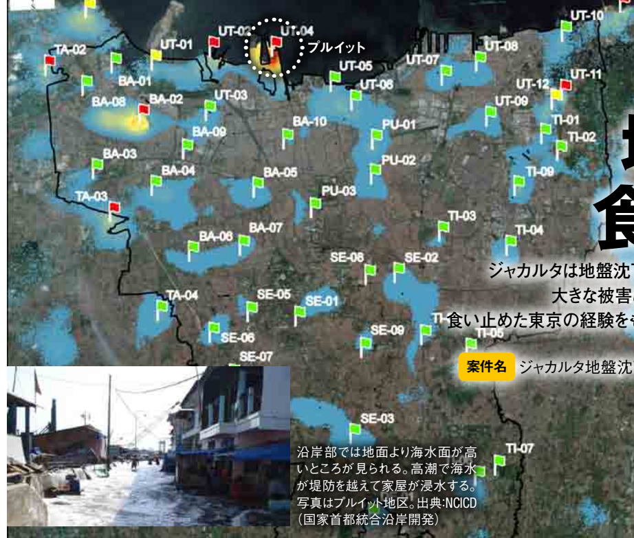
陸域観測技術衛星「だいち」と「だいち2号」によるジャカルタ市内の地盤沈下の衛星画像解析結果。水色の箇所は2007～18年に50ミリ以上沈下したところを、赤や黄の旗はさらに沈下が激しいところを示す。©JAXA／ジャカルタ地盤沈下対策プロジェクト共同企業体
