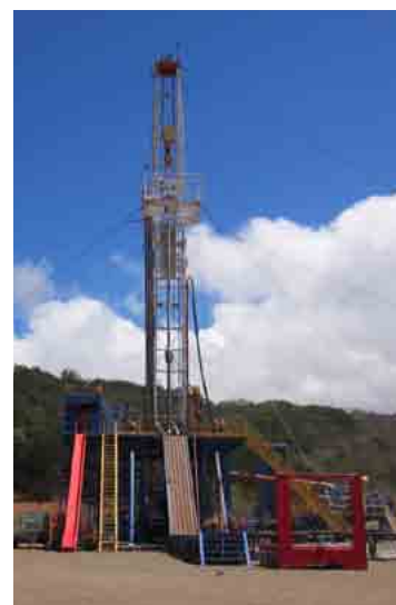
ラス・パイラス2の掘削現場。地下深部から熱水や蒸気を取り出し、発電のエネルギー源として使う。
