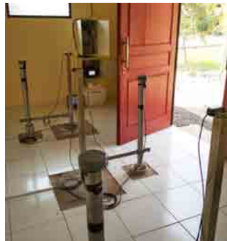
観測井戸。1か所につき深さの異なる3本の井戸を建設している。各井戸は二重構造になっており、地盤が沈下するとその分だけ内側のパイプも沈む。3本の井戸のパイプの沈み具合の差で、各地層での収縮の度合いを計測する。
