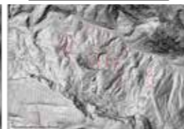
JICAの支援で取り入れられた高解像度の地形図「LiDAR-DEM(ライダーDEM)」。航空機から地表にレーザーを照射して測量する。
