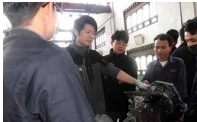
教材車から取り外したトランスミッション（変速機）を生徒に見せて構造を 説明する坂本さん（左から2人目）。
