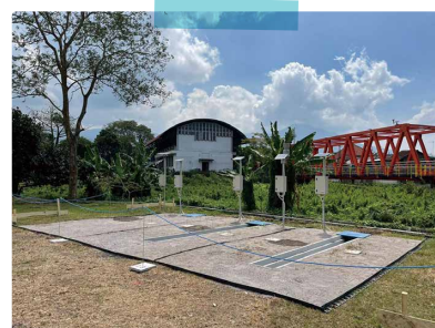
軟弱地盤でのポーラスコンクリート 製品性能試験の様子
