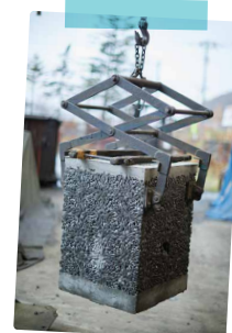
雷おこしの様な外見の ポーラスコンクリート製品
