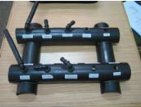
نموذج تدريبي يبين الطريقة الصحيحة والخاطئة لتركيب إكسسوارات الأنابيب
