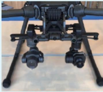
UAV搭載型サーモグラフィカメラ
