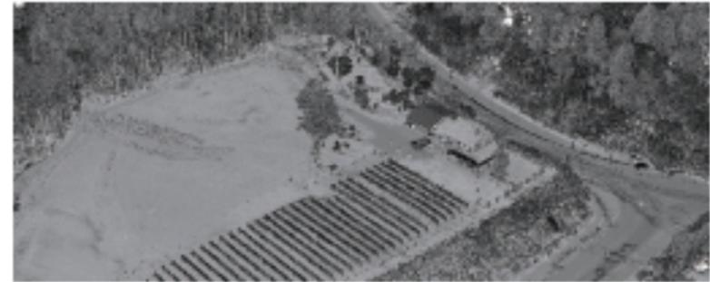
空中写真及び3Dレーザスキャナによる計測のデータから三次元点群データを作成。詳細な地物・地形データは様々な検討データとして応用可能。
