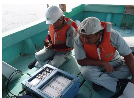
海上での測量作業の様子(音響測深器)
