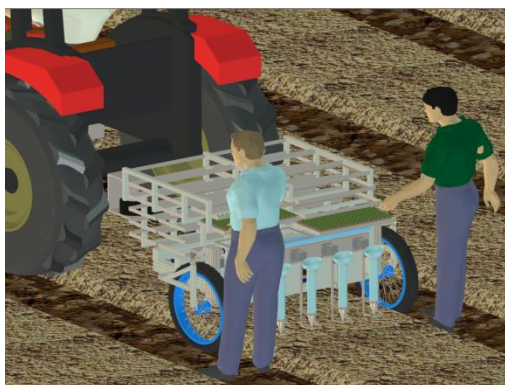
ブラジルで需要の高い牽引式半自動移植機
