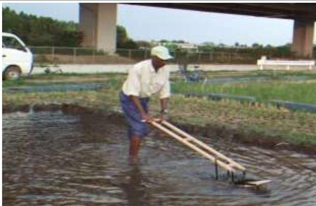
試作した除草機の性能評価試験をするウスマンさん
