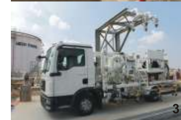
1 新技術の運用方法など、現地スタッフへの指導も徹底して行われた 2 空港内に4000klを貯蔵できる燃料タンク4基を設置。タンクから地下へと伸びる配管を通じて燃料が送られる 3 航空機への給油はサービサーと呼ばれる特殊車両をパイパスして行われる
