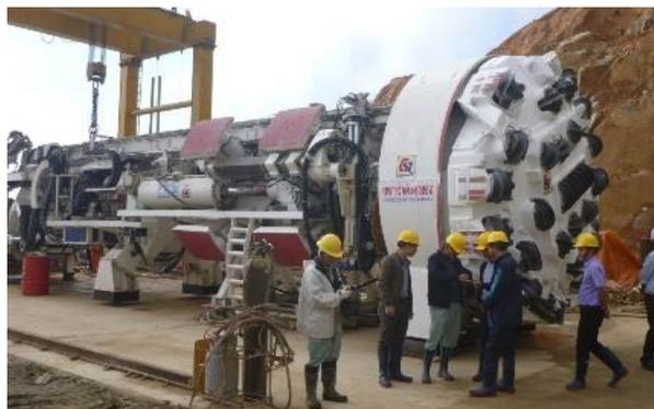
トンネル掘削機械（TBM）の先端部
