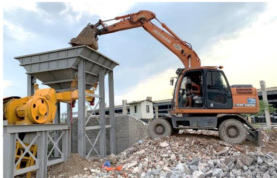
SATREPS プロジェクトで建設廃棄物をリサイクルに向けて破碎するための作業をする建設廃棄物破碎機（2020年9月撮影）
