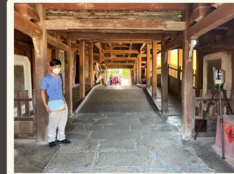
Số hóa 3D bằng công nghệ scan laser
