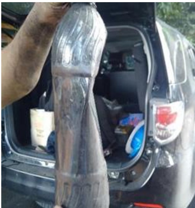
Hình 2: Chai PET bị biến dạng do mẫu than anthracite thử nghiệm hấp thụ ô xy
