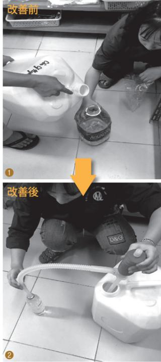
①②巡回先の機械部品製造会社で「小集団活動」により実現した職場改善の例。部品の洗浄に使うアルコール溶媒を子分けにする作業が、以前は2人がかりで行われていたが、①、給油用のポンプを使って1人で行うようになった②
