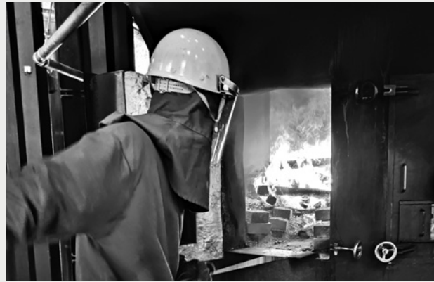
まきの火で発酵液を熱して蒸留を行う工程。「蒸気やガスではなく、まきで加熱するのが当社の特色で、担当になった週は一日中、ボイラーにまきを入れ続けます」
